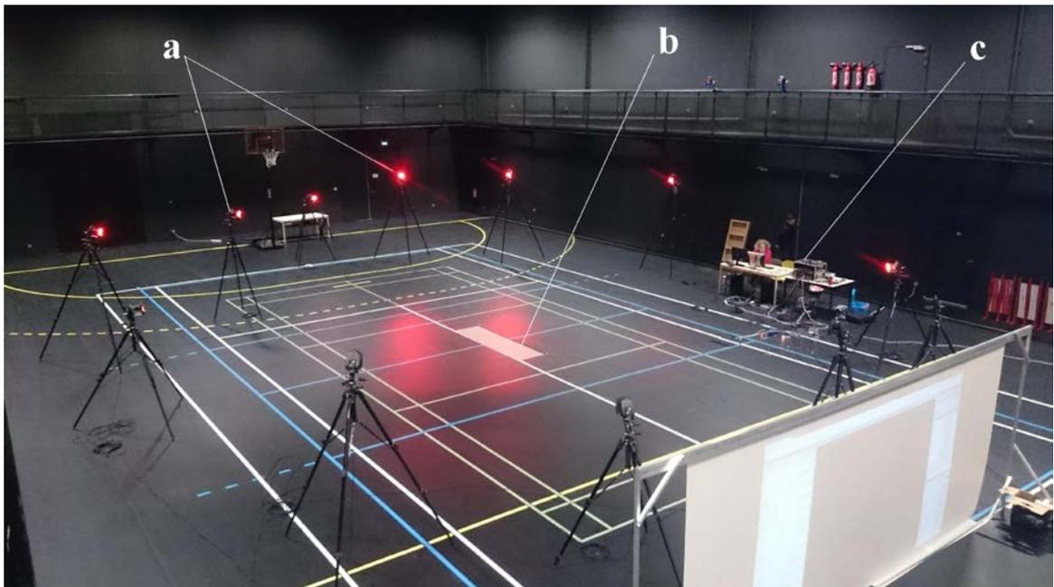
**Figure 3. Disposition des outils : Caméras infrarouges (a), plaques de force (b) et matériel informatique (c)**
