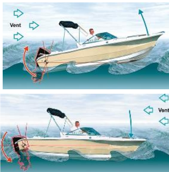
Figure 2 : Illustration fonctionnement TRIM [18]
